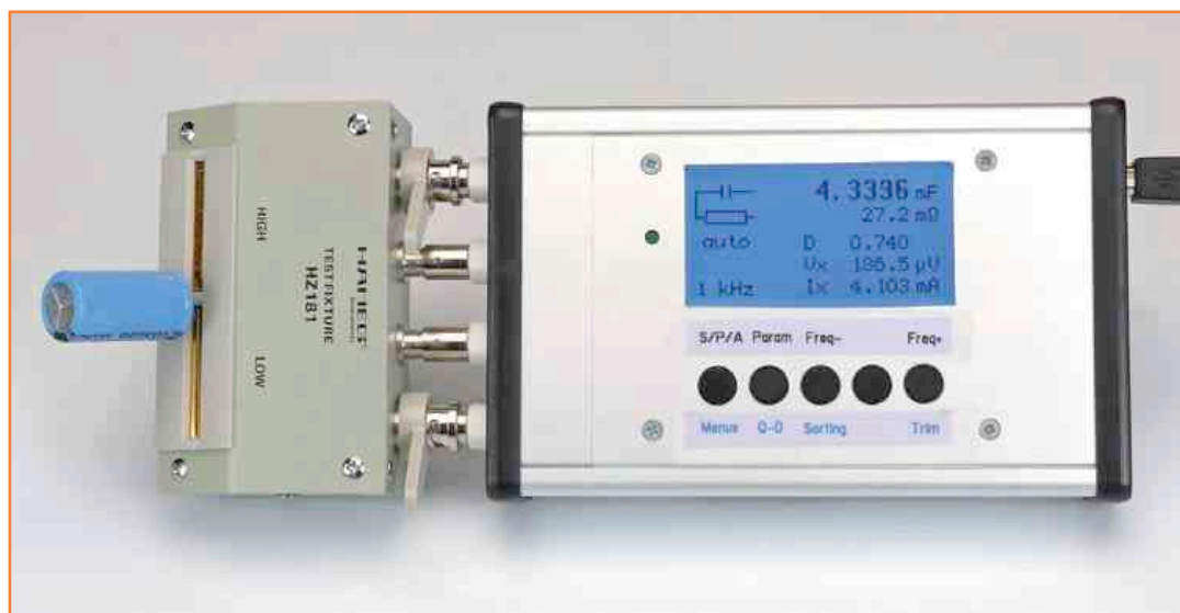
Bild 7b. Der Messkopf von Hameg passt unmittelbar auf die LCR-Meter-Anschlüsse.
